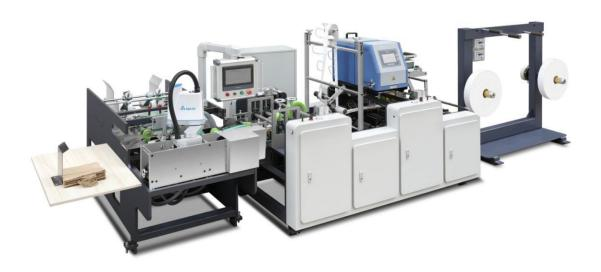
本机设计与我们的纸袋机配套使用,可以生产纸绳手把,然后将手把粘在纸袋上,制成手提纸袋。 本机以两根窄纸卷和一根纸绳卷为原料,将纸带和纸绳粘在一起,逐渐切断形成纸手把。 此外,该机还具有自动计数和上胶功能,可大大提高用户后续加工作业的效率。
